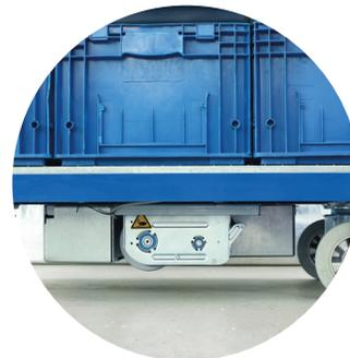
E-Drive optima ne touche pas le sol (=position haute) lorsque le système n'est pas activé ou lorsqu'il n'est pas utilisé.
